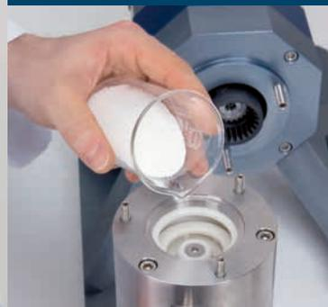
*Die Befüllung der Mahlkörper ist bei demontiertem Mahlbereich und geöffnetem Frontdeckel leicht auszuführen.*
